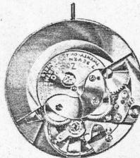
Mouvement ancre, avec remontage automatique, seconde au centre, calendrier, aiguille GMT
